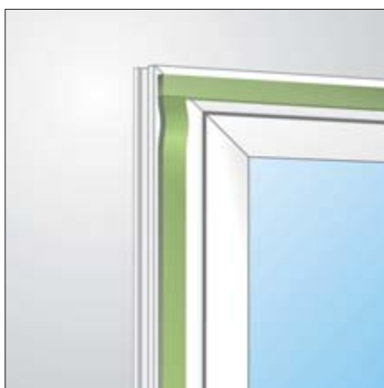
Bild 3: Bandverlegung bei der Fenstermontage
