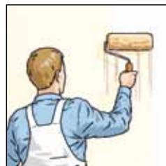
**9.** Klimaplatte mit lösungsmittelfreiem Grundbeschichtungsstoff grundieren.
